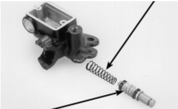
PISTÓN DEL CILINDRO MAESTRO
