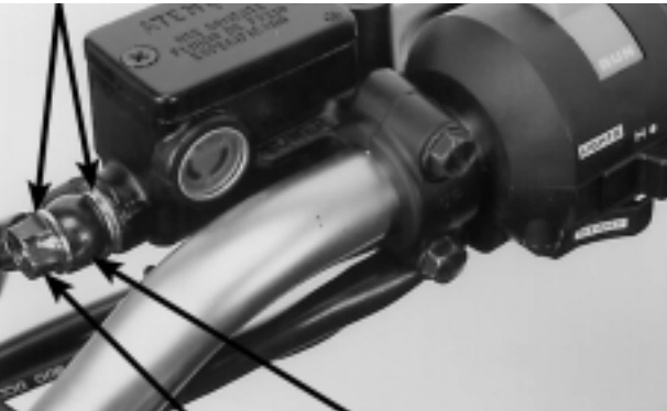
PERNO BANJO CONEXIÓN DE LA MANGUERA
